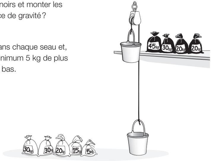
Une **poulie** est un dispositif mécanique constitué d'une pièce en forme de roue qui sert à la transmission d'un mouvement. Ce dispositif peut être construit avec une courroie, une corde, un câble ou une chaîne. On l'utilise pour soulever une charge : accrochée à une extrémité d'une corde passant par une poulie fixée à un support, la charge peut être déplacée en exerçant une force à l'autre extrémité de la corde.
