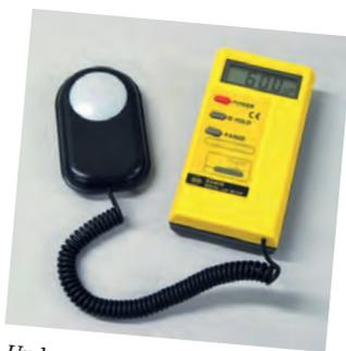
Un luxmètre, utilisé par les photographes en particulier : capteur permettant de mesurer l'éclairage ; cette mesure s'exprime dans une unité appelée « lux », et non en candela.
